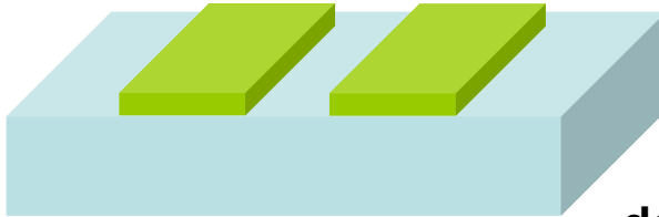
Ligne à fente (slot line)
