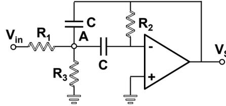
$$V_{th} = V_{in} \frac{R_3}{R_1 + R_3}$$
